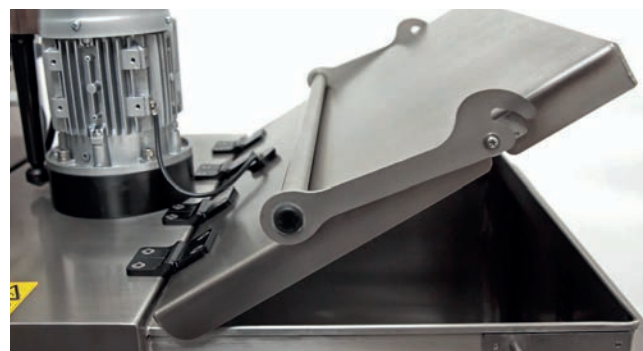
Tankdeckel mit Easy-Stop Scharnieren
