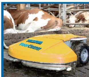
Die Bauhöhe ist mit 40 cm gering, die Fahrgeschwindigkeit von 4-20 m / min variabel zu steuern.
